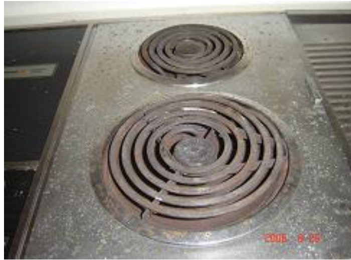
Corrosión de las hornillas en cocinas
